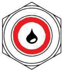
Le bouton-poussoir de l'USE reste allumé rouge en continu. Appeler le service technique immédiatement ! Éteindre le poste de traitement au niveau de l'interrupteur principal ! Le détecteur de débordement s'est déclenché ! Le capteur de niveau de remplissage et/ou l'électrovanne sont défectueux.
